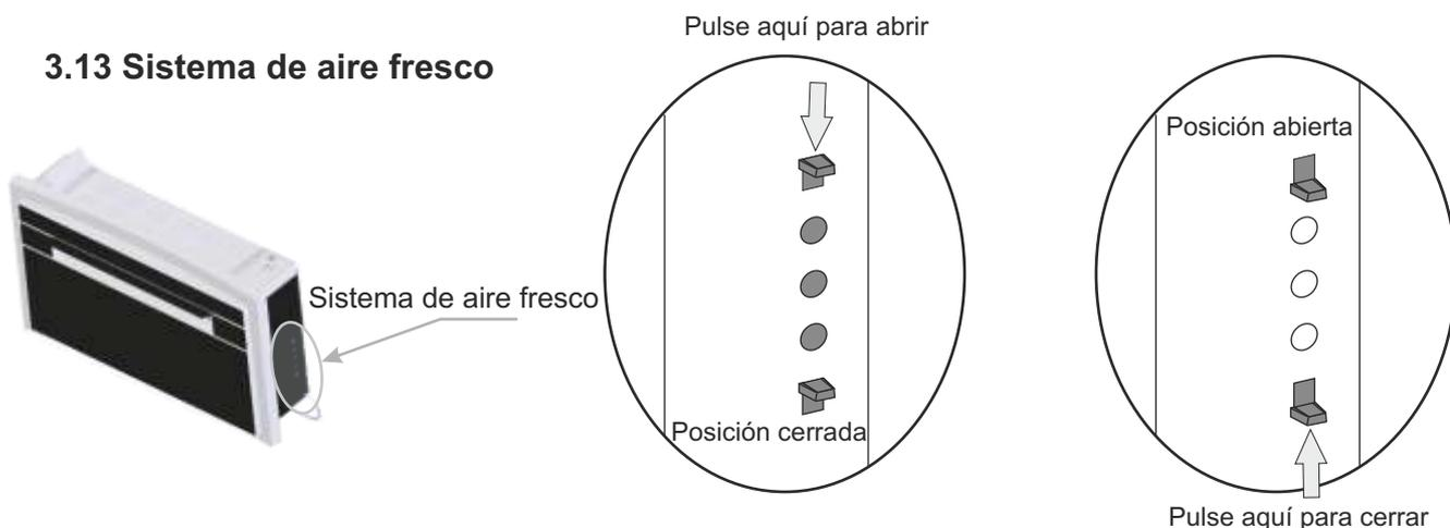
Cuando el sistema de aire fresco está abierto, el acondicionador de aire cambiará el aire de la habitación automáticamente: de esta manera ingresará a la habitación aire fresco y limpio. Puede abrir o cerrar el sistema de aire fresco en cualquier momento. Si el sistema de aire fresco está cerrado, el rendimiento del acondicionador de aire es mayor, de modo que le aconsejamos de mantener el sistema de aire fresco cerrado y abrirlo durante algunos minutos por día.
