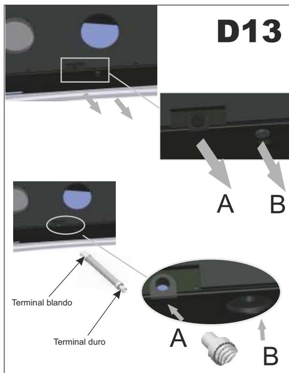
El sistema "A" se utiliza comúnmente, y la tubería de descarga va hacia el exterior donde no hay problema para conectarla o drenarla, esta es la solución adecuada para países calientes y con temperaturas exteriores normalmente frescas.
