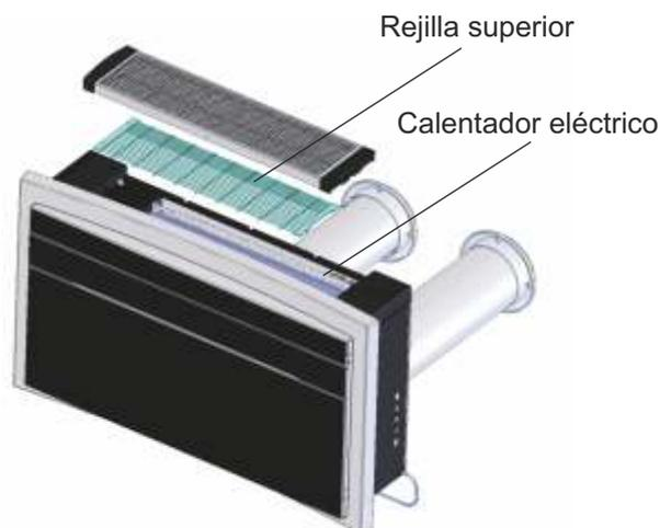
La resistencia eléctrica está situada en la parte superior del equipo y está protegida por la rejilla superior.
