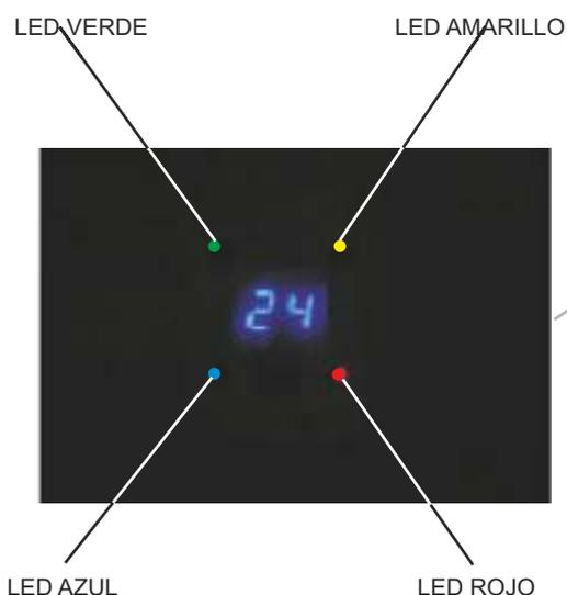
El visor mostrará la temperatura configurada y la temperatura ambiental. Luego de ajustar la configuración de temperatura, ésta parpadeará en el visor, luego el visor mostrará la temperatura ambiental durante 70 segundos. Finalmente, el visor se apagará hasta el próximo ajuste.
